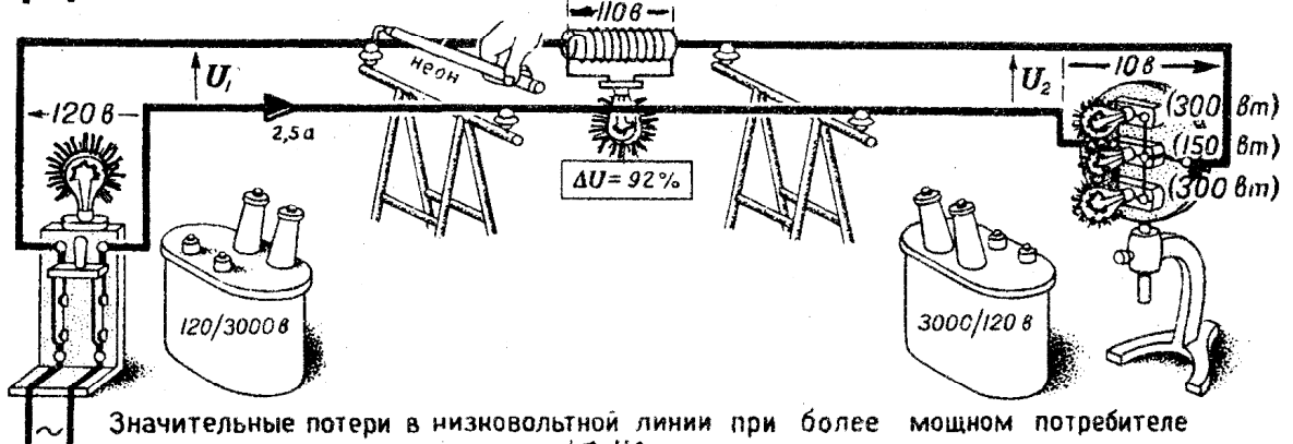
Малые потери в низковольтной линии при небольшой мощности потребителя
